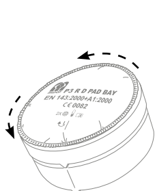
Retire o filtro de partículas rodando para a esquerda (em sentido anti-horário).
