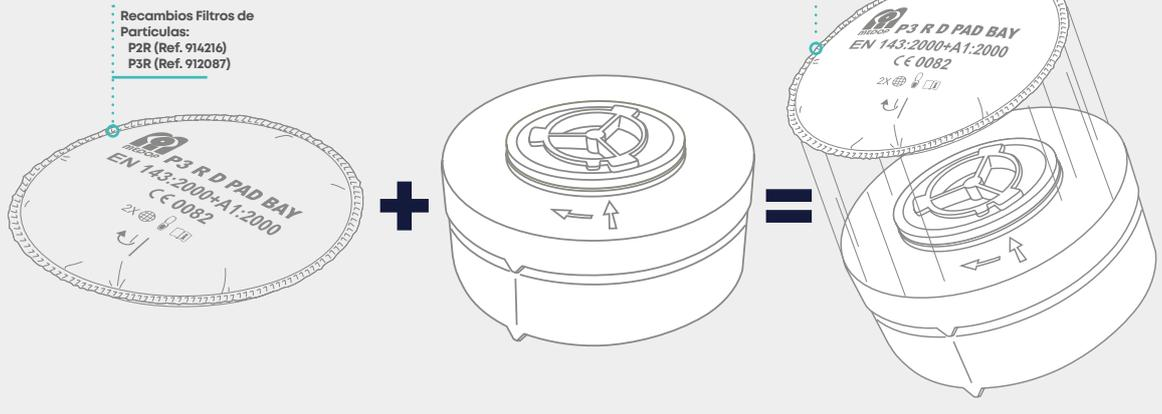
LOS FILTROS JOIN combinan un filtro de partículas con un filtro de gases permitiendo a su vez utilizar cada uno de ellos individualmente: 1 productos, 3 soluciones. Ambos filtros permiten su uso simple (directamente en la buconasal) o combinado (acoplados ambos filtros).
