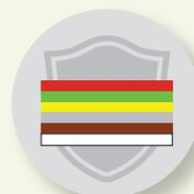
Proteção contra: vapores orgânicos com ponto de ebulição inferior a 65° C, gases e vapores inorgânicos, gases ácidos, dióxido de enxofre (SO<sub>2</sub>), amoníaco (NH<sub>3</sub>) e os seus derivados orgânicos, vapores de mercúrio, pó, fumos e névoas.
